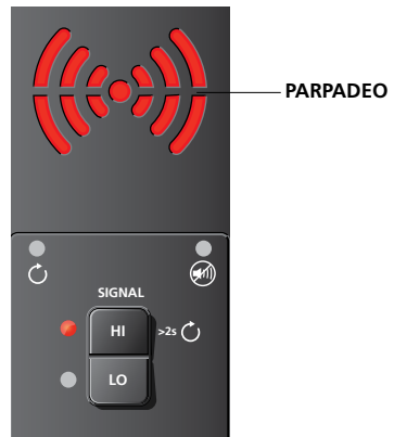
Figura 4.12b: Indicador del Transmisor que muestra la señal en modo Loop (Bucle)
