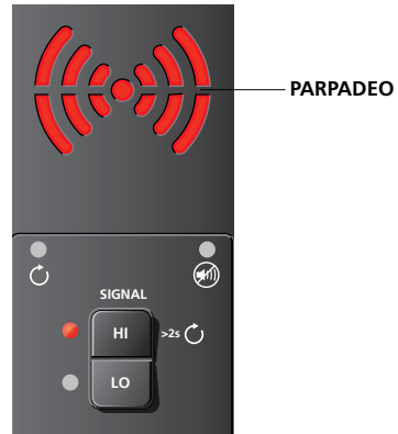
Figura 3.1b: Indicador del Transmisor que muestra la señal en modo HIGH (Alta)
