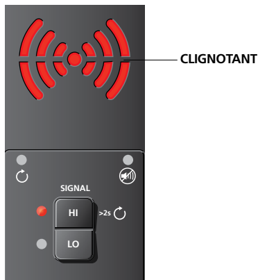
Figure 4.12b : Voyant du transmetteur indiquant un signal en mode boucle
